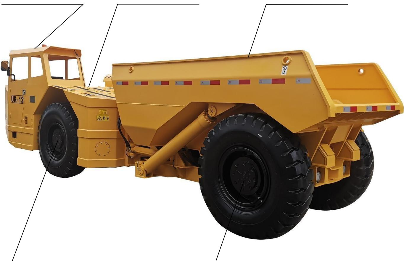
Marco oscilante de montaje del eje delantero, ángulo de oscilación ± 8 °
