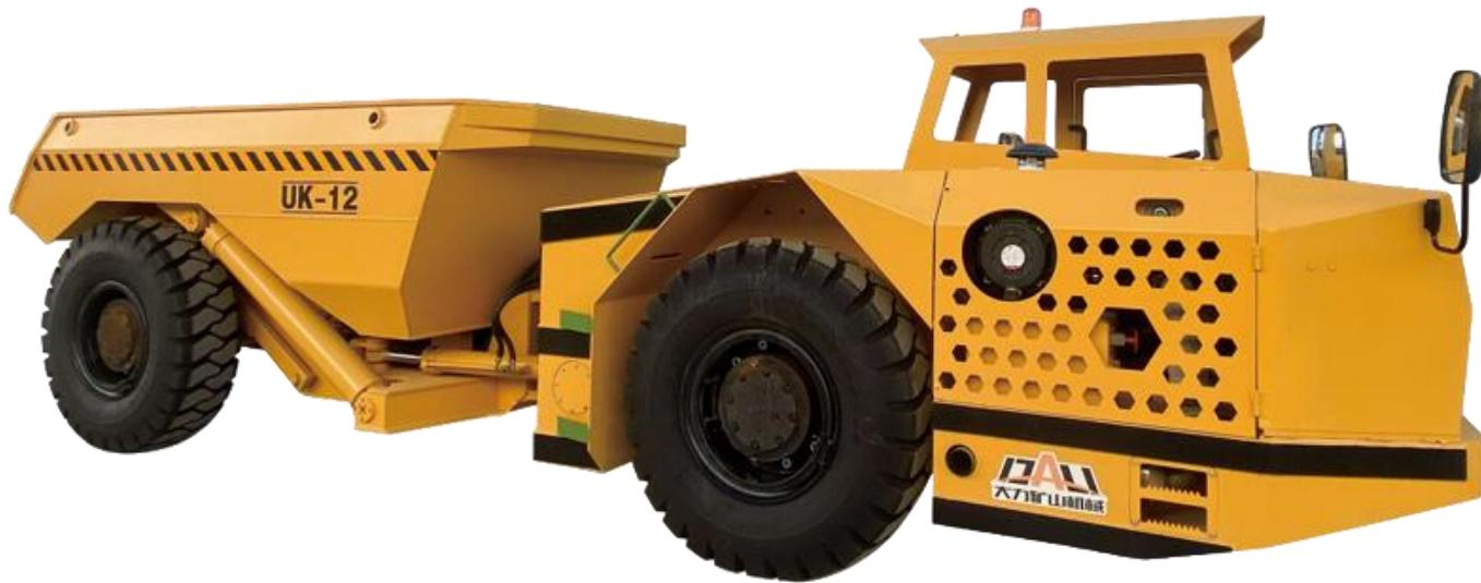
UK-12 es un camión subterráneo articulado con una carga de 12 toneladas. Diseño de transporte rápido y eficiente en operaciones mineras y de construcción pequeñas y medianas. La construcción de uk-12 tiene en cuenta la seguridad y la facilidad de operación.
